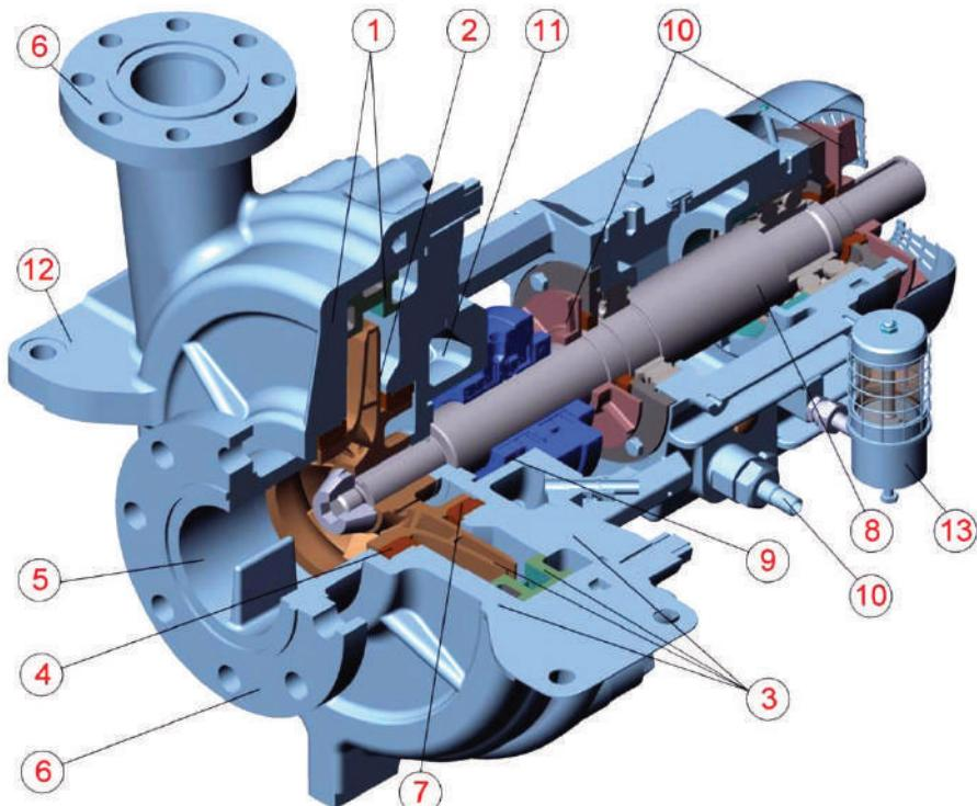
**9** Камера уплотнения вала выполнена согласно API 610 11-й редакции, что позволяет использовать торцовые уплотнения, соответствующие API 682 различных производителей.
