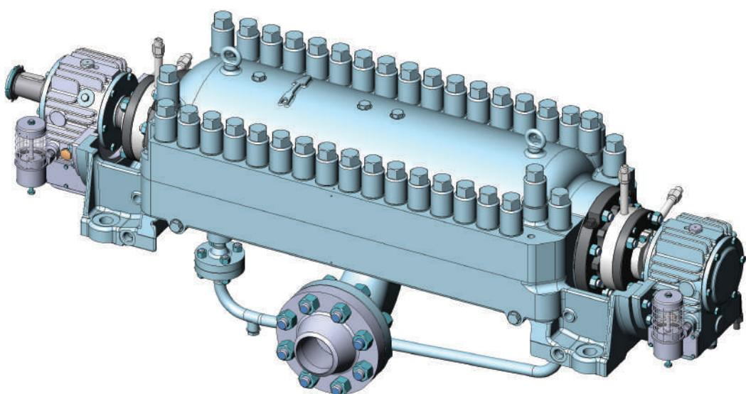
В конструкцию насоса внесено множество улучшений в соответствии с требованиями стандарта API 610 – чугунные корпуса подшипниковых опор заменены на стальные, концы валов со стороны привода выполнены с конической посадкой вместо цилиндрической, штуцерные соединения заменены на фланцевые, предусмотрены площадки для замера вибрации в трех направлениях, и т.д.
